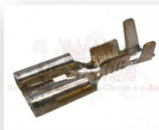
TERMINAL FÊMEA ESTANHADO FIO 0,75 A 1,5MM COM TRAVA 6,3MM CÓD.0571 007
