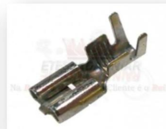
TERMINAL FÊMEA ESTANHADO FIO DE 2,5 A 6,0MM COM TRAVA 6,3MM CÓD.0571 008
