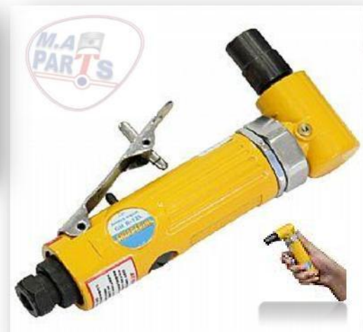
7600 013 Retífica angular • Informações Técnicas: - Entrada de ar: 1/4" - Pinça: 1/4" - Rotação: 12000 rpm - Pressão de operação: 90 lbf/pol 2 (psi)/ 6 kgf/cm 2 - Ar consumido: 113 l/min 4pcm • Marca: Chiaperini
