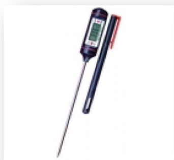
8002 009 TERMÔMETRO ESPETO Termômetro digital com sensor de aço inoxidável. Usado em refrigeração, aquecimento, laboratório, alimentos e condicionamento de ar em geral. Faixa de temperatura: -50°C +300° ou -58°F a + 572°F
